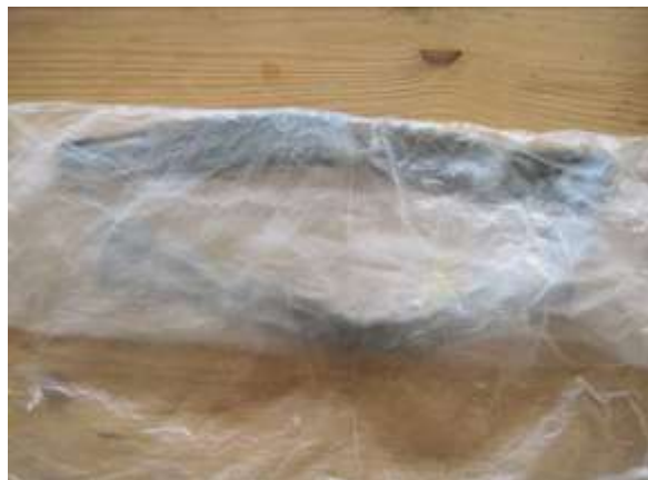
A festékrétegek duzzasztása CMC-vel pasztásított Kromofággal.
