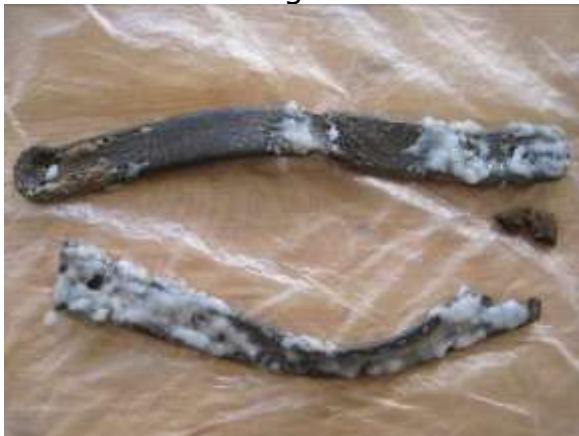
A festékrétegek duzzasztása CMC-vel pasztásított Kromofággal.
